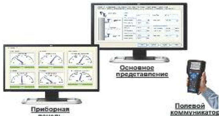
Рис. 4. Одни и те же данные об устройствах и показаниях ERS-системы могут быть предоставлены пользователям с помощью программного обеспечения AMS Suite Device Manager в обычном и графическом виде, а также на переносном устройстве (полевом коммуникаторе)
