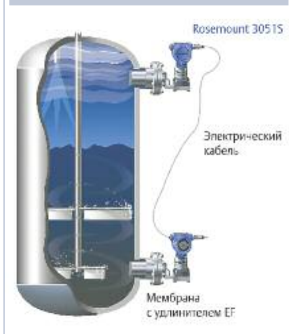
Рис. 2. Установленное на патрубки решение на базе ERS от Emerson
