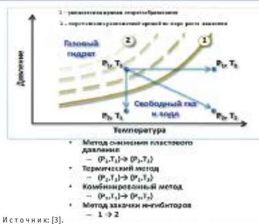
Рис. 1. Методы разработки газогидратных залежей
