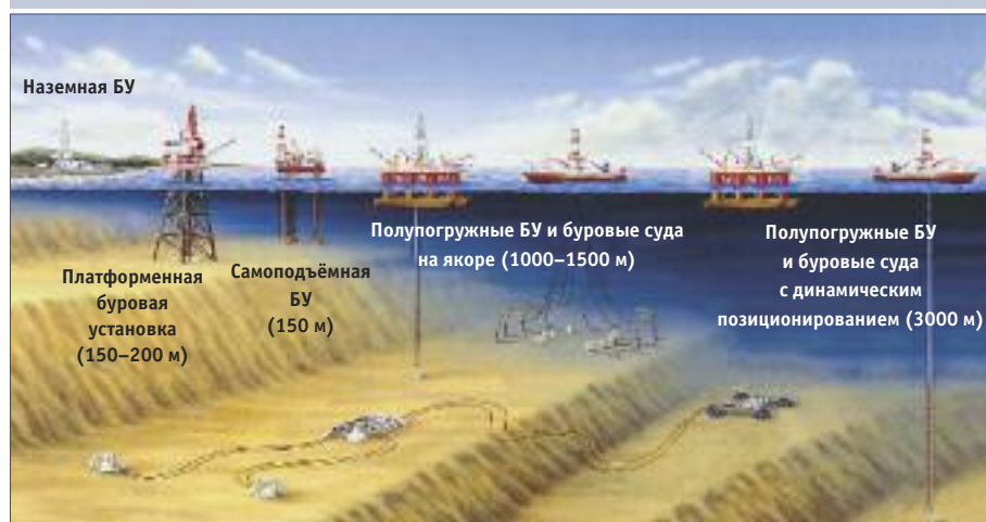
Рис. 1. Основные виды буровых платформ по глубинам применения
