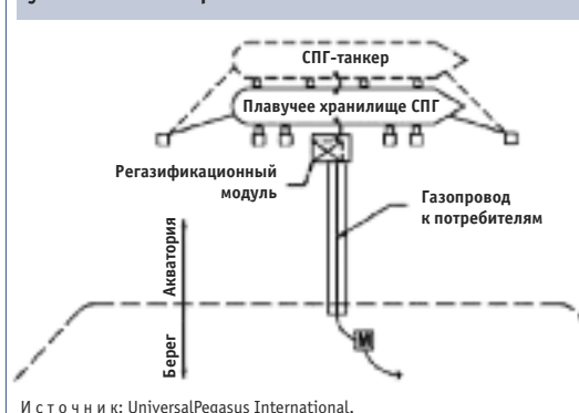
Рис. 5. Схема комбинированного терминала с модульной установкой на пирсе
