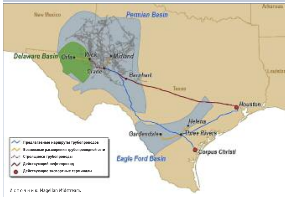
Рис. 4. Районы Eagle Ford и Permian: схема расположения и основные элементы нефтетранспортной инфраструктуры
