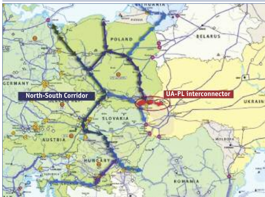
Рис. 1. Схема расположения интерконнектора между ГТС Польши и Украины
