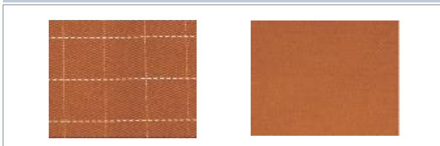
Рис. 2. Структура «обычной» ткани и ткани «ИнвизиблАнтистат»
